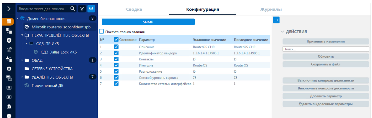
Рис. 358. Отображение значений параметров сетевого оборудования на вкладке «Конфигурация»
