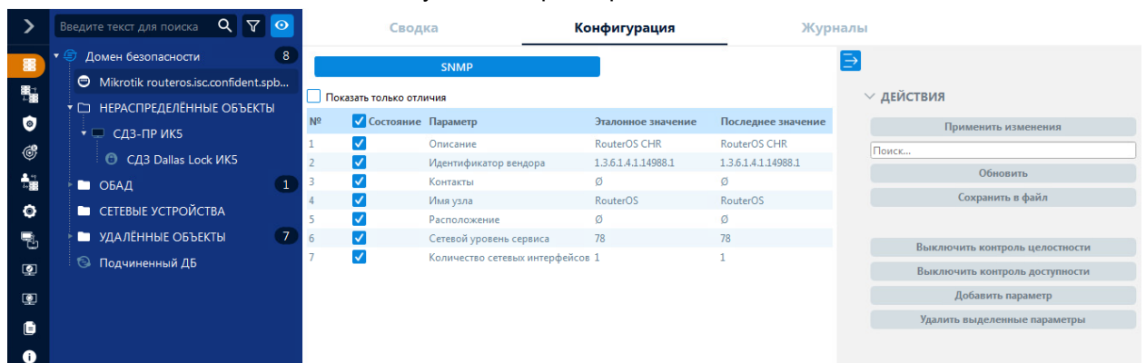
Рис. 356. Отображение значений параметров сетевого оборудования на вкладке «Конфигурация»
